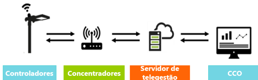
Figura 9 – Estrutura operacional do Sistema de Telegestão
