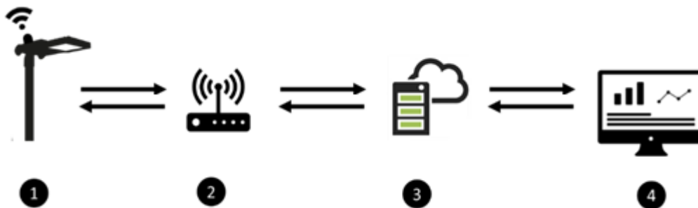
Figura 10 – Estrutura operacional do Sistema de Telegestão
